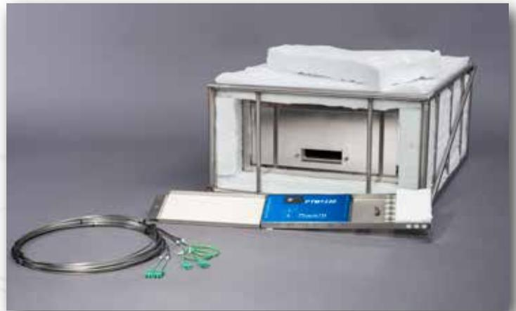
Für CSP Prozesse ist ein sehr flaches, mit einem Messfühlerarm ausgerüstetes System verfügbar, das im laufenden Ofenbetrieb auf eine Bramme gelegt werden kann. Damit können bis zu 6 Oberflächentemperaturen und zusätzliche Atmosphärentemperaturen aufgezeichnet werden.
