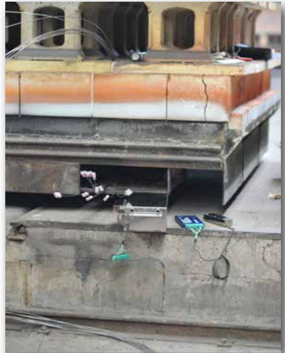
Die optionale Radio-Telemetrie sendet die Temperaturdaten in Echtzeit auf Ihren PC. Auch bei sehr langen Öfen kann durch die Verwendung von mehreren Repeatern die Funkübertragung gewährleistet werden. Sollte trotzdem einmal eine Unterbrechung der Übertragung auftreten werden die nicht empfangenen Daten automatisch noch einmal gesendet.
