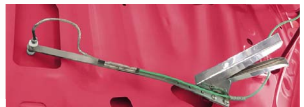
Messfühler mit Klammer für Oberflächen- und Lufttemperaturen
