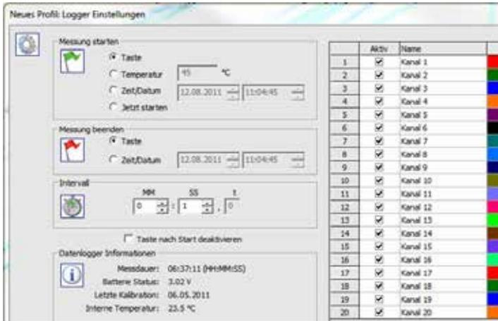
Einfach Messtakt, Startbedingung und die Anzahl der verwendeten Messfühler eingeben. Für regelmäßige Messungen erledigen Sie diese Einstellungen mit nur einem Mausklick.
