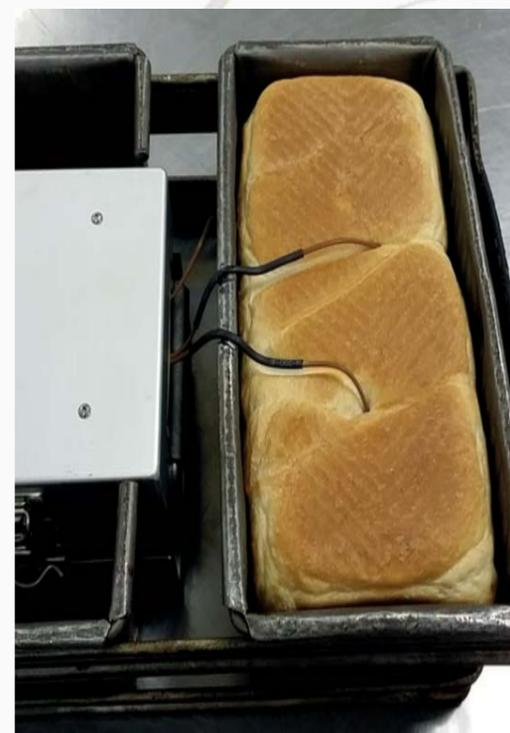
In Prozessen mit höheren Temperaturen, wie z.B. Backprozessen, können auch TS04 Hitzeschutzbehälter ( in einer Edelstahlausführung für leichte Reinigung) verwendet werden. Diese Systeme sind in einer Vielzahl von Standardvarianten oder auch mit individuellen Abmessungen lieferbar, um ein ideales System für Ihren Prozess zusammenzustellen.
