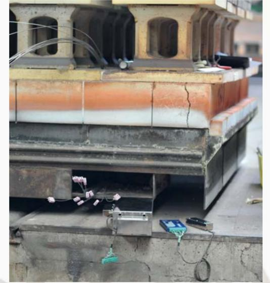
Auch für Rollenherdöfen sind Systeme verfügbar. Hier fährt das System direkt durch die Feuerzone und nimmt über die Messfühler zuverlässig Produkt- und Umlufttemperaturen auf.
