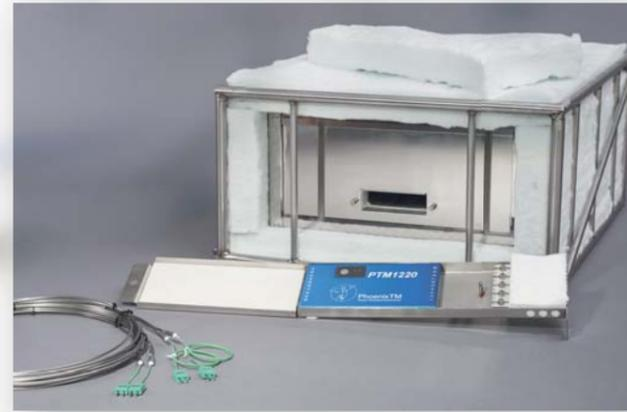
In die Konstruktion der TS07 Systeme ist die Erfahrung aus vielen Jahren eingeflossen. So werden z.B. die Messfühler auf dem Loggerahmen fixiert: Dies erleichtert die Montage und wirkt gleichzeitig als Zugentlastung; darüber hinaus werden bei der Demontage des Systems die Stecker vor zu großer Wärme geschützt.
