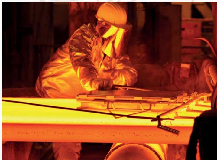
Für CSP Prozesse ist ein sehr flaches, mit einem Messfühlerarm ausgerüstetes System verfügbar, das im laufenden Ofenbetrieb auf eine Bramme gelegt werden kann. Damit können bis zu 6 Oberflächentemperaturen und zusätzliche Atmosphärentemperaturen aufgezeichnet werden.
