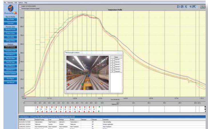
Concernant les paramètres, il suffit d'introduire un temps d'échantillonnage, les conditions de départ et le nombre de thermocouples. Pour des mesures fréquentes cela peut être fait en un clic.
