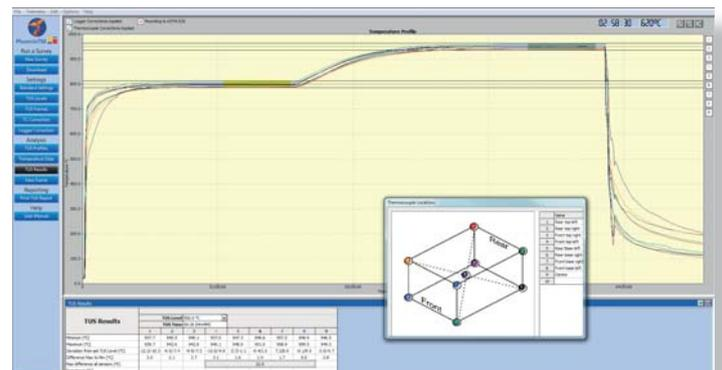
Le logiciel Thermal View Survey, disponible en option, permet l'établissement automatisé de rapports conformément aux normes AMS2750E et CQI-9.
