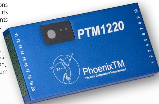
Transmission des données par télémétrie, en temps réel depuis l'intérieur de l'installation.
