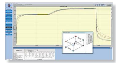
Le logiciel Thermal View Survey, disponible en option, permet l'établissement automatisé de rapports conformément aux normes AMS2750E et CQI-9.
