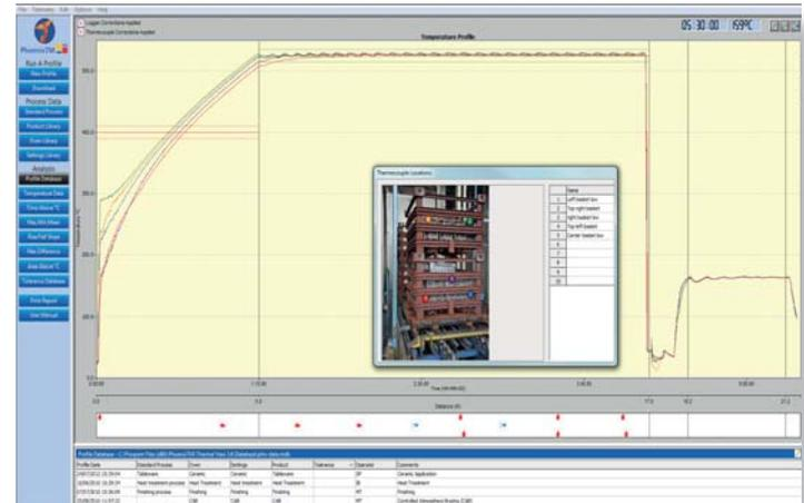
Concernant les paramètres, il suffit d'introduire un temps d'échantillonnage, les conditions de départ et le nombre de thermocouples. Pour des mesures fréquentes cela peut être fait en un clic.
