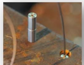
Für die Oberflächenmessfühler der Mini Mill Systeme verwenden wir 2mm Messfühler und bewegliche Befestigungen mit hohem Gewicht für einen sicheren Kontakt zur Bramme.
