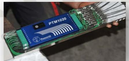
Die interne Loggeraufnahme für einfaches Handling der Messfühler schützt den Logger auch vor zu großer Hitze beim Entladen.
