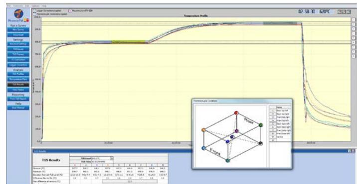
Des outils d'analyse complets sont affichés sur la gauche de l'écran, afin, d'un simple clic, d'avoir accès aux données-, et de déclencher un rapport. Importer et exporter des données est possible, dans les formats .csv et PhoenixTM, permettant un transfert électronique des données du processus surveillé.
